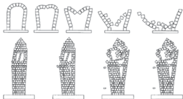
Slika 17. Seizmičko ponašanje i način kolapsa za dvije različite zidane konstrukcije izložene potresnom opterećenju [109]
